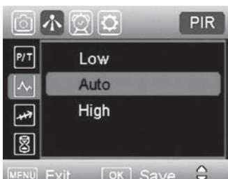
**Déclenchement PIR :** Déclenche lors d'un mouvement ou différences de température.
