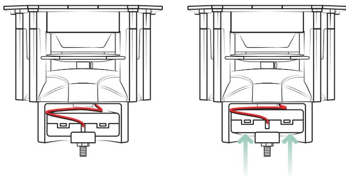
Rimuovere con cautela la scatola delle batterie (11) dal vano (10) avendo cura di non strappare il collegamento del cavo.
