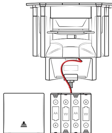
Far scorrere il coperchio del vano batterie (11a) sulla scatola (11). Spingere nuovamente la scatola delle batterie (11) con il collegamento del cavo nel vano batterie (10) e premere nuovamente la scatola nel supporto.
