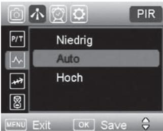
**PIR Auslösung:** Löst bei Bewegung und Temperaturunterschieden aus. Wählen Sie diesen Modus und gehen Sie durch drücken „MENU“ ins Menü „Auslösemodus“ zurück. Jetzt stellen Sie die folgenden Funktionen ein:
