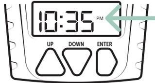
Um die aktuelle Uhrzeit einzustellen, drücken Sie die Taste ENTER (09). Die Stundenziffern blinken und Sie können mit den Tasten UP (07) und DOWN (08) die aktuelle Stunde eingeben. Mit der ENTER Taste (09) bestätigen Sie die Stunde und gelangen zur Eingabe der Minuten (Minutenziffern blinken).
