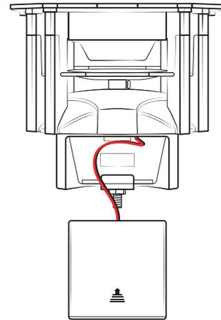
Schieben Sie den Batteriefachdeckel (11a) gemäß Markierung in Pfeilrichtung auf. Bestücken Sie die Batteriebox mit **4 Stück Mignon Batterien AA LR6 1,5V** oder mit entsprechenden, wiederaufladbaren AA Akkus (nicht im Lieferumfang enthalten). **Achten Sie beim Einlegen der Batterien auf die korrekte Polung +/-** (Markierungen innen in der Batteriebox).
