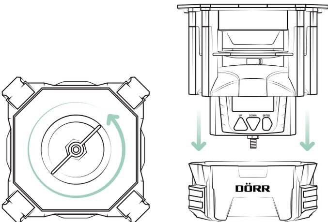
Auf der Rückseite des Futterstreuers befindet sich das Batteriefach (10) mit der Batteriebox (11).
