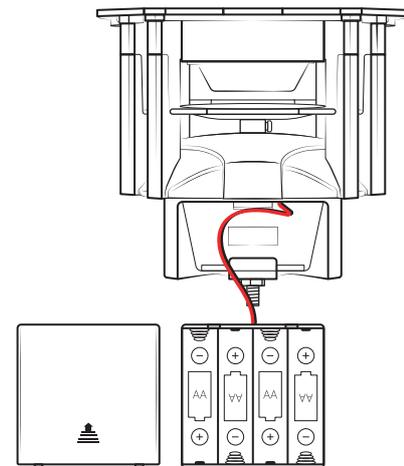
Schieben Sie den Batteriefachdeckel (11a) wieder auf die Batteriebox (11). Legen Sie die Batteriebox (11) mit der Kabelverbindung wieder in das Batteriefach (10) und drücken Sie die Batteriebox wieder nach unten in die Halterung.
