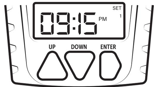
Nach Eingabe der Minuten, drücken Sie die ENTER Taste (09) um die **Streudauer** einzustellen (Sekundenziffern blinken). Mit den Tasten UP (07) und DOWN (08) kann eine Streudauer von **1-30 Sekunden** eingegeben werden:
