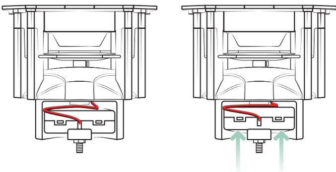
Nehmen Sie die Batteriebox (11) vorsichtig aus dem Batteriefach (10) ohne die Kabelverbindung abzureißen.
